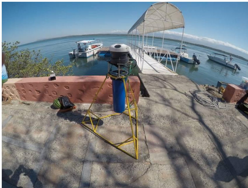
Figura 1. AWAC instalado en Cabo Blanco
